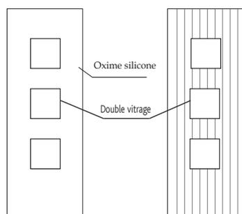
2 panneaux de 7 mm Komacel, classement M1, collés par double face adhésif sur le vitrage isolant
